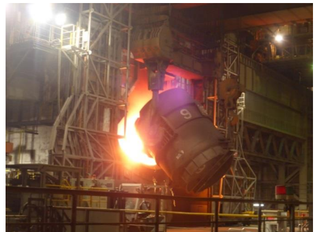
【稼動中の脱りん炉】
